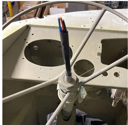
Câblage électrique au niveau du volant.
