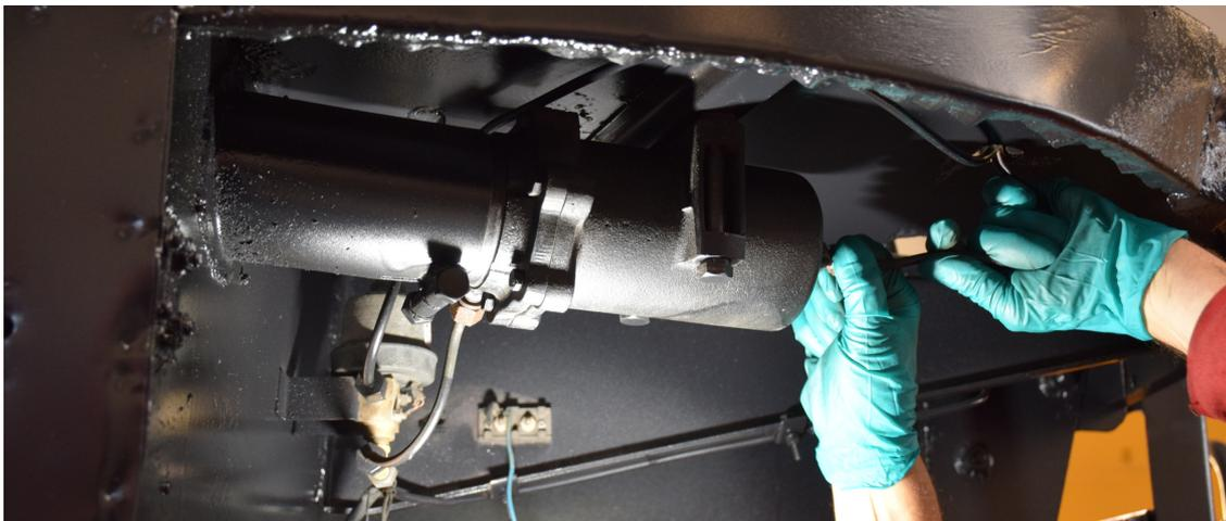
Le vérin de porte avant, remis en place et raccordé aux réseaux électriques et d'air.
