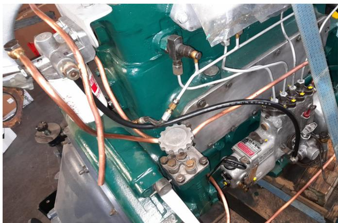
Les raccords d'alimentation en carburant restent à poser.
