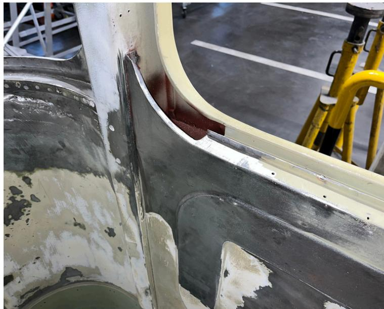
De la même manière, au niveau de la porte du milieu, des travaux de reconfection ont été effectués. Une voussure a été démontée afin d'atteindre la rouille entre la toiture intérieure et la toiture extérieure.
