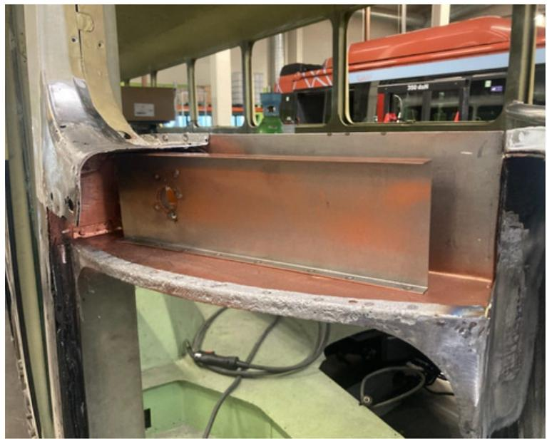
Une barre supplémentaire a été soudée de manière provisoire afin de conserver les côtes, et éviter que le caisse ne se déforme. Une fois la pièce recrée sur mesure, la barre en métal a été dessoudée.
