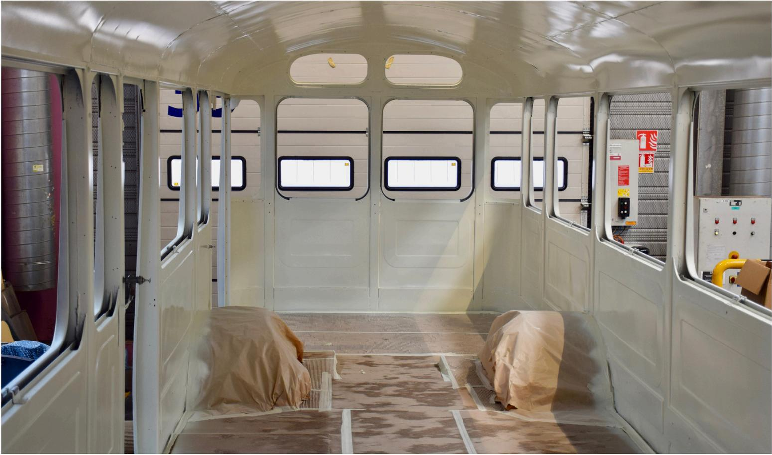
Plusieurs éléments intérieurs ont également été peints : les goulottes permettant le passage des câbles électriques sur les parois et le plafond, les platines d'éclairage, les cadres des fenêtres, le tableau de bord, le capot du bornier (tableau électrique du véhicule) et de l'albanèse, les panneaux lumineux "arrêt demandé" situé au plafond et "complet" au dos du receveur.
