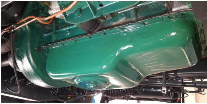
Le carter moteur a été poncé puis entièrement repeint. Celui-ci se situe dans le bas moteur et contient toute l'huile nécessaire à son bon fonctionnement (de type 15W40). Une peinture haute-température a été utilisée.
