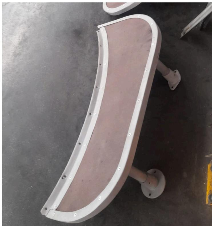
Les deux repose-pieds des places assises sur l'essieu avant sont d'origine. Ces derniers ont été sablés. Sur ces pièces, le tapis de sol marron d'origine sera conservé afin de montrer la couleur d'origine du tapis de sol du bus. Malheureusement, aucun fabricant ne fabrique ce type de sol aujourd'hui et nous avons dû nous tourner vers une couleur grise (avec néanmoins un motif identique).
