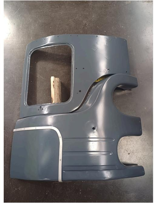
Très corrodés et abîmés, les panneaux de carrosserie des angles avant et arrière ont été confiés à la SAFRA pour une rénovation complète. Toute la rouille a disparu. A l'arrière, les éléments étaient en aluminium. Malheureusement trop abîmés, leur réutilisation n'a pas pu avoir lieu. De nouveaux éléments ont été refabriqués sur mesure.
