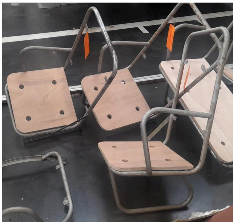
Les experts des ateliers de Tisséo ont découpé toutes les pièces en bois pour la reconstruction des dossiers et des assises, ainsi que des dos des sièges. Les trous visibles permettent de chasser l'air contenu dans la mousse lorsqu'un passager s'assied. L'ossature du siège conducteur a quant à elle été repeinte. Les ossatures des sièges passagers seront repeintes plus tard, à la fin de la création de la nouvelle sellerie.
