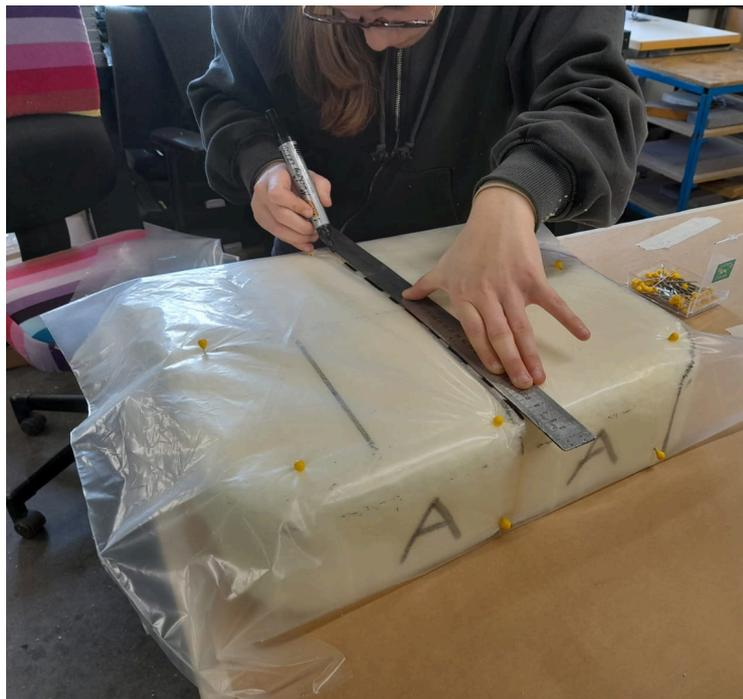
Le siège conducteur, composé de deux coussins a été le premier à être réalisé. Le choix des matériaux s'est porté vers des modèles de Skaï ignifugés, répondant à toutes les normes de sécurité actuelles. L'aspect est par ailleurs identique à celui d'origine, avec un rendu marbré.
